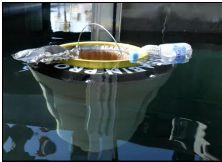
Rajah 7 Perangkap Sampah Jenis Mesin ( Seabin )
