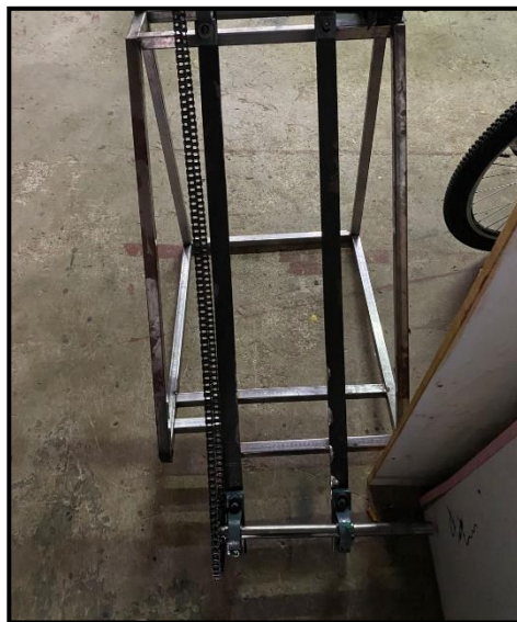
Rajah 27 pemasangan rantai dan spocket.
