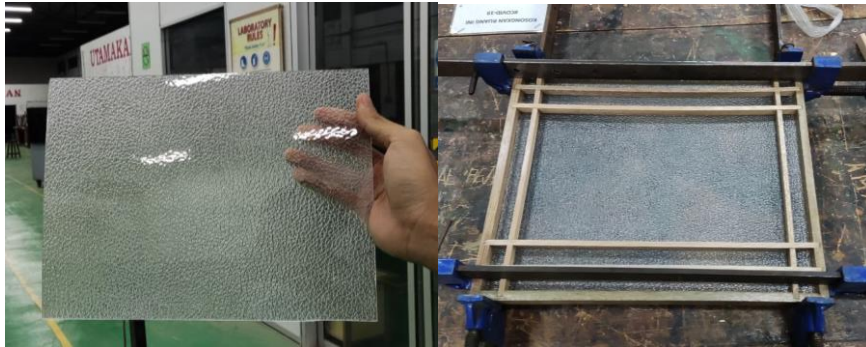
3.17 : Proses penyediaan bahan polikarbonat
