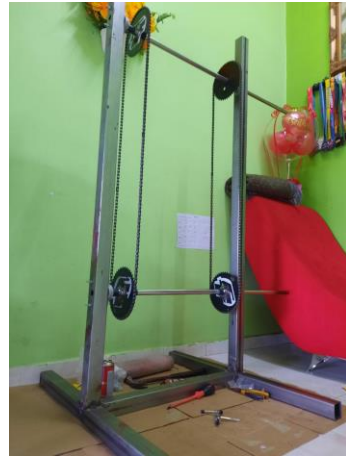
Rajah 3.17: Pemasangan rantai.
