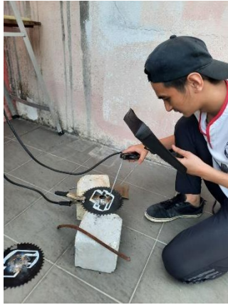
Rajah 3.15: Pengimpalan dan Skru pemegang shaft dan bearing.
