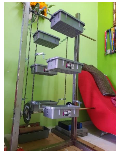
Rajah 3.18: Pemasangan dan penyekruan pemegang kotak dan kotak.
