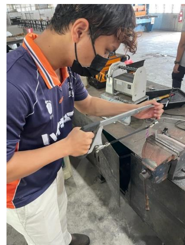
RAJAH 3.4 (iv): Proses Pemotongan Kepingan Aluminium
