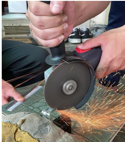
RAJAH 3.4 (iii): Proses pemotongan braket
