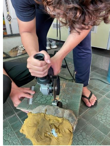
RAJAH 3.4 (iii): Proses pemotongan braket
